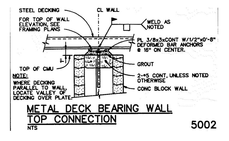
WALL ANCHORAGE CONNECTION DETAIL ALONG INTERIOR WALL ELEVATIONS
