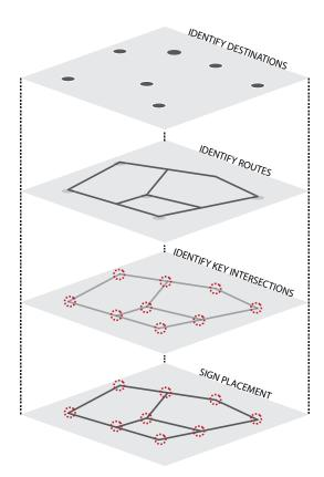
Fig. 5 Wayfınding System Logic
